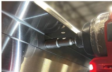
**2.** Dévissez les trois (3) vis hexagonales de 0,9 cm situées sur le cadre supérieur de chaque porte à l'aide d'un tournevis de 0,9 cm.
