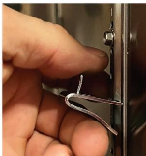
**1.** Retirez les rayons. Trouvez l'emplacement de l'attache de pilastre et appuyez fermement sur la base de l'attache pour le faire glisser et le sortir de son logement.
