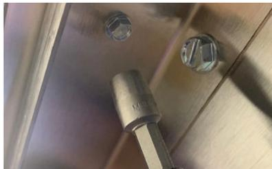
**1.** Trouvez l'emplacement des vis hexagonales sous la face inférieure du plateau en inox et dévissez-les à l'aide d'un tournevis hexagonal de 0,6 cm. (Ignorez les étapes 1 à 3 si votre appareil est doté d'un plateau brut)
