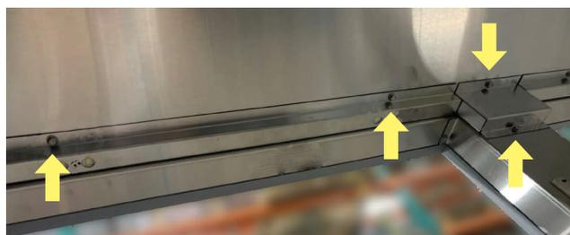
**4.** Remettez toutes les vis en place. Vérifiez que les fils ne sont pas comprimés sous les nouveaux supports.
