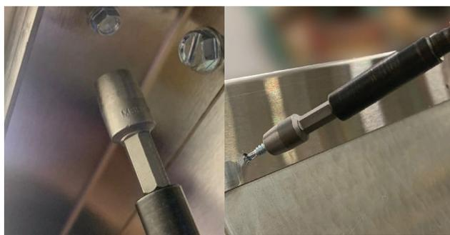
6. Fixez solidement le nouveau plateau en vissant les vis hexagonales à l'arrière et à l'avant de l'appareil.
