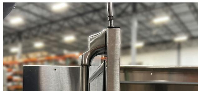
4. Mettez en place la nouvelle poignée en alignant le support supérieur avec les trous situés sur le dessus de la porte. Fixez solidement avec les anciennes vis.
