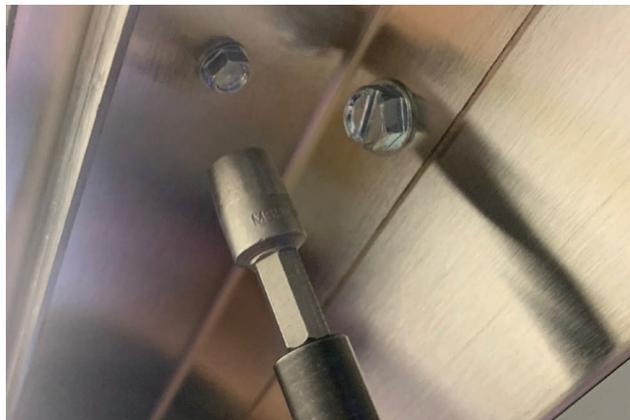
2. Retirez les vis hexagonales de 0,6 cm de la partie avant de l'appareil, au-dessus des portes. Mettez les vis de côté. Elles seront utilisées sur le nouveau plateau de réfrigération.
