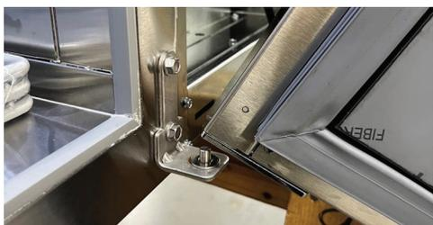
**4. Pour les appareils dotés d'un plateau brut :** Alignez la nouvelle porte avec la charnière inférieure et vissez à nouveau les trois (3) vis hexagonales supérieures de 0,9 cm pour fixer solidement la porte.
