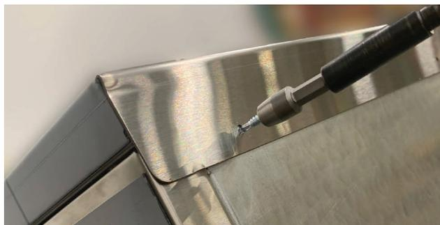
4. Retirez les vis hexagonales de 0,6 cm de la partie arrière de l'appareil. Mettez les vis de côté. Elles seront utilisées sur le nouveau plateau de réfrigération.
